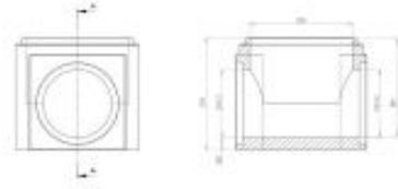
Ausführung mit Gerinne in Beton, geklinkert, GFK, Epoxidharzbeschichtung oder Gerinne geschlossen mit eingebautem Putzstück möglich.
