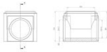
Ausführung mit Gerinne in Beton, geklinkert, GFK, Epoxidharzbeschichtung oder Gerinne geschlossen mit eingebautem Putzstück möglich. Bermehöhe: Nach Norm oder nach Angabe, Bermeigung 1 : 20 Transportanker auf Wunsch möglich. Winkel, Gefälle und weitere Seitenzulaufe nach Angabe. Ausführung in Falzverbindung (T2), Muffenverbindung (T1) und Rösser Expert möglich.
